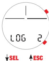
Память NEPTO позволяет записывать до 32 профильных часов с частотой кадров 2 секунды.
