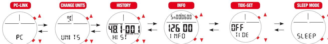
В системном режиме можно загружать данные на ваш Mac или ПК, изменять системные настройки, выполнить сброс устройства и т.д. На экране SYSTEM нажмите **SEL** для доступа к следующим функциям: PC, UNITS, HIST, INFO, TIDE, SLEEP.
