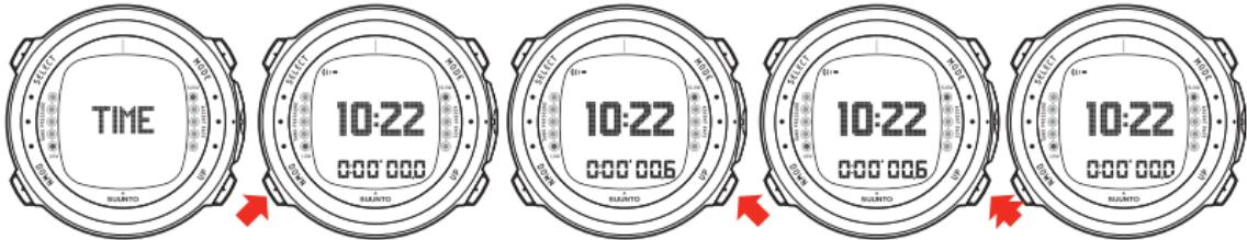
ВОСПОЛЬЗУЙТЕСЬ КНОПКОЙ DOWN ДЛЯ ЗАПУСКА СЕКУНДОМЕРА И ИЗМЕРЕНИЯ ВРЕМЕНИ . КНОПКА UP ОСТАНАВЛИВАЕТ СЕКУНДОМЕР, А ПРОДОЛЖИТЕЛЬНОЕ НАЖАТИЕ СБРАСЫВАЕТ ЕГО ПОКАЗАНИЯ.
