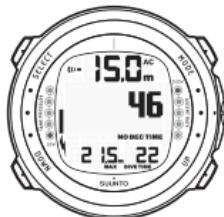
ДИСПЛЕЙ ПОГРУЖЕНИЯ - ТЕКУЩАЯ ГЛУБИНА 15 М, БЕЗДЕКОМПРЕССИОННЫЙ ПРЕДЕЛ ВРЕМЕНИ 46 МИН. МАКСИМАЛЬНАЯ ГЛУБИНА ПОГРУЖЕНИЯ СОСТАВЛЯЛА 21,5 М, С НАЧАЛА ПОГРУЖЕНИЯ ПРОШЛО 22 МИН.
