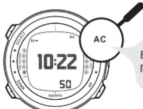
СИМВОЛ AC ОТОБРАЖАЕТСЯ В ПРАВОМ ВЕРХНЕМ УГЛУ ДИСПЛЕЯ ПРИ КОНТАКТЕ ПОДВОДНОГО КОМПЬЮТЕРА С ВОДОЙ.
