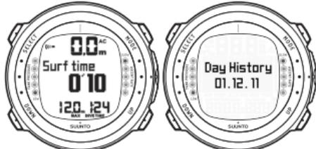
Функция Day History (История дня) отображает среднюю глубину всех погружений, максимальную глубину текущего дня, а также время, самое длительное погружение и суммарное время погружений в часах и минутах, а также число погружений, выполненных в течение дня.
