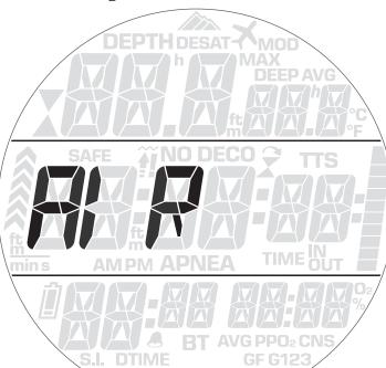
Выбор **NitROX** откроет для вас подменю, в котором вы сможете выставить процент кислорода (%O<sub>2</sub>) в смеси и верхний предел парциального давления кислорода (ppO<sub>2</sub>max) для максимум трёх дыхательных смесей. Максимально возможное значение ppO<sub>2</sub>max – 1.6 бар. Большинство обучающих дайвингу ассоциаций рекомендуют не превышать значение 1.4 бар.
