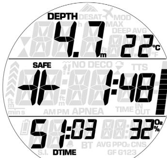
Секундомер начнется после завершения обычной остановки безопасности, но будет виден только после завершения остановки **SAFETY STOP +**.
