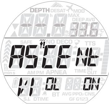
Превышение скорости всплытия на 120 % на протяжении отрезка глубины более 20 м приведёт к блокировке компьютера на 48 часа с целью предотвращения повторных погружений. Это вызвано риском возникновения пузырьков. В этом меню вам даётся возможность отключить функцию блокировки компьютера в случае неконтролируемого всплытия.
