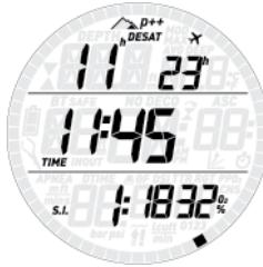
При ненулевом времени запрета полётов или времени рассыщения экран после погружения станет основным экраном по умолчанию. Нажатие **DOWN** позволит вам просмотреть все остальные экраны, но по истечении 8 секунд компьютер автоматически вернёт всё к показу экрана после погружения. В течение всего периода рассыщения компьютер будет показывать краткий лог прошлого погружения: максимальную и среднюю глубину в верхней строке, время погружения и установленный процент кислорода в нижней.
