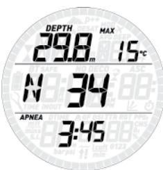
Нажатием **UP** вы откроете логи отдельных погружений. Погружения с аквалангом описаны в разделе 2.5. Погружения на задержке дыхания сгруппированы в серии, причём каждая серия получает две сводные страницы: первая показывает максимальную глубину и минимальную температуру серии, дату и время начала серии, а также порядковый номер;
