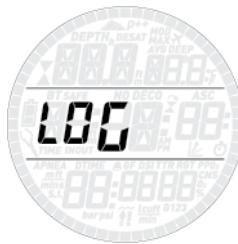
В памяти Smart Air могут храниться профили последних примерно 95 часов под водой, записанные с частотой 12 обновлений в минуту. Информация с вашего логбука может быть с помощью приобретаемого отдельно интерфейса с разъемом USB перенесена на компьютер (PC), для чего потребуется программа Dive Organizer, или на Mac - для этого служит программа Divers' Diary. Кроме этого, Smart Air покажет вам основную информацию прямо на экране.
