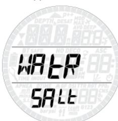
Компьютер можно настроить на **FRESH** (ПРЕСНУЮ) или **SALT** (МОРСКУЮ) воду или воду, соответствующую калибровке EN-319 в зависимости от места погружений. Неверный выбор воды влечёт за собой ошибку измерения глубины в пределах 1-3% (т.е., на глубине 30 м пресной воды компьютер с установкой "морская" покажет 29 м, а в солёной воде на той же глубине
