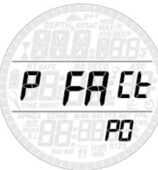
Если пользователь желает проявить большую осторожность, (например, если планируемое погружение связано с повышенной физической нагрузкой), Smart Air позволяет повысить уровень консервативности вычислений. Здесь вы можете перейти от стандартного алгоритма (P0), к наиболее консервативному (P2) или среднеконсервативному (P1). На экранах перед и после погружения, в логбуке и дайв-планировщике уровень P0 не отображается никак, P1 выглядит как p+, а P2 как p++.
