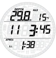
Нажатием **UP** экран переключается на показ максимальной глубины и минимальной температуры за всю серию погружений в верхней строке, максимальной длительности погружения в серии в средней и текущего времени - в нижней. При просмотре сводки по серии погружений деления в верхней половине экрана будут загораться, при просмотре индивидуальных погружений - не будут.
