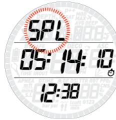
Секундомер может также показывать промежуточные значения: нажмите во время его работы кнопку **DOWN** - и показания прибора замрут на экране (в верхней строке будет мигать **SPL**, а отсчёт секунд продолжится в фоновом режиме). При каждом повторном нажатии **DOWN** экран будет показывать обновлённые показания секундомера. Для выхода из этого режима нажмите и удерживайте кнопку **DOWN**. При замерах промежуточного времени кнопка **UP** не используется.
