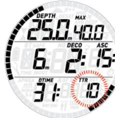
Кроме того, при снижении давления до уровня, установленного в качестве НЗ или **TANK RSV**, деления шкалы давления и его цифровое значение перейдут в мигающий режим, и раздастся звуковой сигнал. Нажатие любой кнопки остановит звуковой сигнал, но деления шкалы давления на экране останутся в мигающем режиме. Если до срабатывания сигнала цифровое значение давления не было показано на экране, после сброса сигнала экран вернётся к показу времени погружения.
