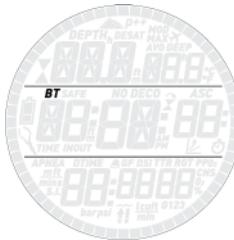
Выбор опции AIR схож с выбором опции EAN с содержанием  $O_2$  21% и  $ppO_2$  max в 1.6bar, с той лишь разницей, что несколько разгружает экран, не показывая CNS (которая вычисляется в фоновом режиме и при достижении которой 75% и 100% выдаются предупреждения).
