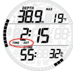
При возвращении под воду до истечения 3 минут времени погружения продолжает отсчитываться с учётом проведённого на поверхности. Если до истечения 3 минут вы не погружаетесь вновь, Smart Air считает данное погружение завершённым, вносит его в логбук и возвращается в режим после погружения.
