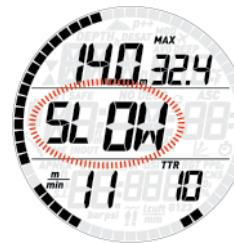
Если на глубинах больше 12 м скорость всплытия превышает 12 м/мин, **!!** также начинает мигать. Если превышение скорости в 12м/мин сохраняется на протяжении двух третей или более от глубины, на которой произошло включение сигнала, то Smart Air регистрирует это погружение как аварийное и на экране появляется **!!**.
