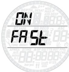
Всплытие считается неконтролируемым, если при подъёме с глубины более чем на двух третях пути скорость всплытия составила 12 м/мин и выше. Это относится только к погружениям глубже 12 м. После неконтролируемого всплытия по причине возможности формирования пузырей Smart Air на 24 часа заблокируется, чтобы удержать вас от повторных погружений. В этом меню вам даётся возможность отключить функцию блокировки компьютера в случае неконтролируемого всплытия.
