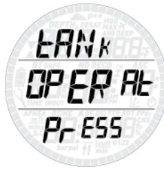
Четвёртое, **tANK WARN (ОСТАЛОСЬ ПОЛБАЛЛОНА)** - значение давления, при котором Smart Air выдаёт соответствующее предупреждение. Этот параметр также может выставляться отдельно для **G1, G2 и G3**. По умолчанию выставлено **100 бар** и **1500 фунтов на кв. дюйм**.
