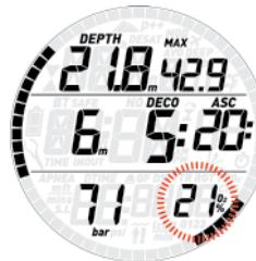
Когда это произойдёт, переключите дыхательную смесь: нажмите **DOWN**, и процент кислорода смеси G2 появится на экране в мигающем режиме вместо процента кислорода G1. Одновременно в правом верхнем углу экрана замигает MOD смеси G2.
