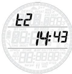
Smart Air предусматривает спящий режим: если вы не носите его кроме как в поездках, прибор можно погрузить в спячку для снижения разряда батареи. Таким образом можно выключить экран, оставив часы работать в фоновом режиме. Работая в спящем режиме, компьютер расходует примерно вдвое меньше энергии, чем в обычном. Для включения спящего режима вызовите на экран "Go to sleep" и воспользуйтесь долгим нажатием **UP**. Пробуждение производится нажатием любой кнопки.
