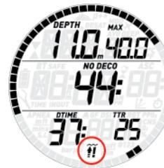
Если после такого погружения пользователь предпринимает повторное погружение, Smart Air блокируется в режиме боттом-таймера и показывает **!!** всё время погружения.
