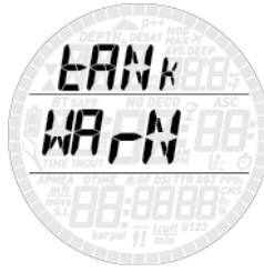
Пятое, **tANK RSRV (Н3 ГАЗА)** - значение давления, при достижении которого подаётся сигнал тревоги, т.к. к этому моменту вы должны быть уже на поверхности. Более того, на основании этого значения вычисляется **TTR (ВРЕМЯ ДО Н3)** (см. 3.2.5 и 3.3). Этот параметр также может выставляться отдельно для **G1, G2 и G3**. По умолчанию выставлено **50 бар** и **500 фунтов на кв. дюйм**.
