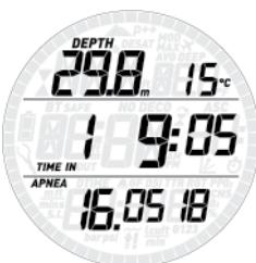
Долгое нажатие **UP** откроет вам вторую страницу с данными о максимальной глубине и минимальной температуре в верхней строке, временем начала серии и количестве погружений серии в средней, самым долгим погружением - в нижней.
