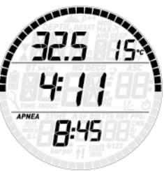
Для выхода из режима апноэ нажмите и удерживайте кнопку **UP**. Выходите из режима только после окончания всей серии, чтобы все погружения серии вместе корректно записались в логбук (см. раздел 3.7.3 о логбуке погружений на задержке дыхания). Smart Air автоматически выйдет из этого режима после 30 минут на поверхности без погружений.
