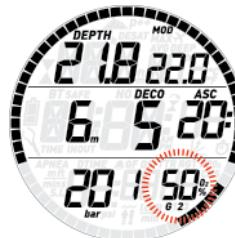
Подтвердите переход на G2 нажатием и удержанием **DOWN**. В правом нижнем углу экрана процент кислорода текущей смеси перестанет мигать. В течение 20 секунд Smart Air пересчитает и покажет общее время всплытия исходя из более высокого процента кислорода в смеси.
